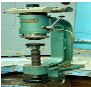
Figura 2.5. Microscopio utilizado para el ensayo de dureza Vickers.
