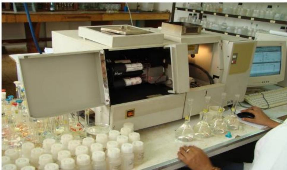
Figura 2.9 Equipo de Espectrometría de Absorción Atómica.
