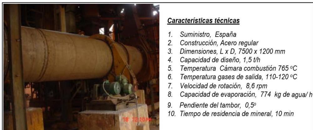
Figura 2.2 Secador de Tambor Rotatorio piloto.
