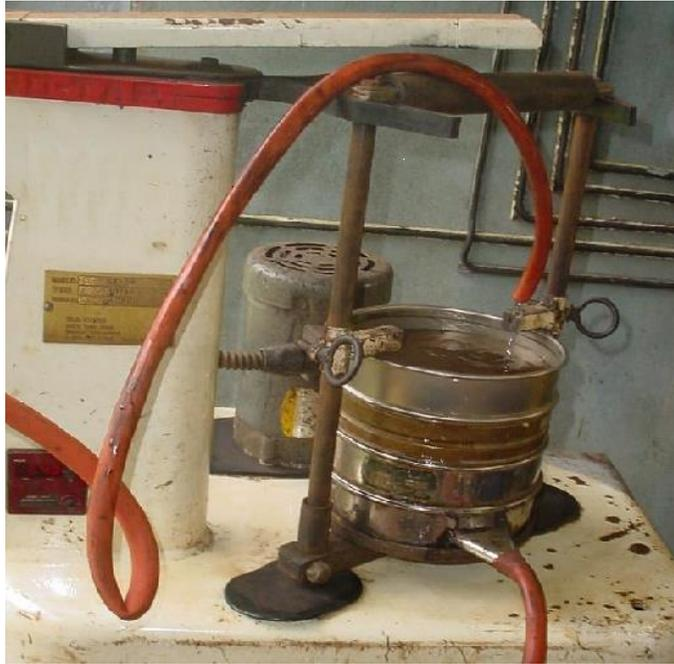
Figura 2.7 Tamizadora por vía húmeda.
