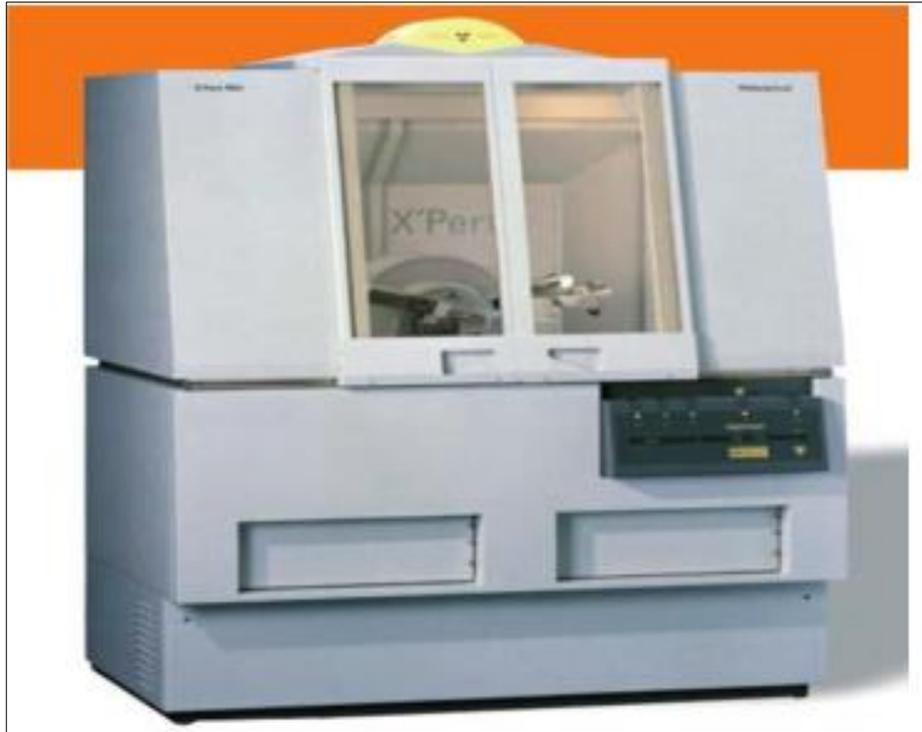
Figura 2.10 Equipo de Difracción de Rayos X.
