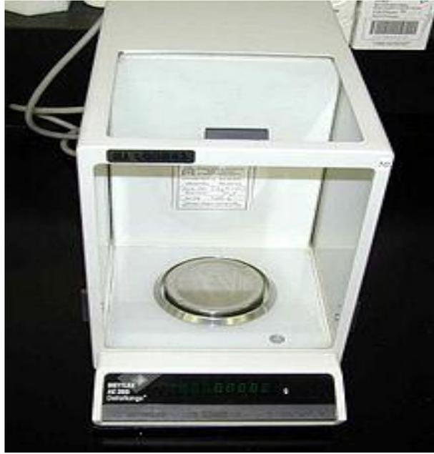
**Figura 2.** Balanza analítica utilizada en el análisis gravimétrico.
