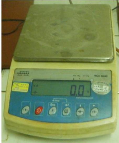
**Figura 5.** Balanza Analítica Digital utilizada en el ensayo de densidad del licor.
