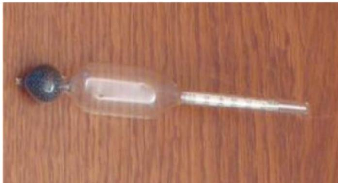
**Figura 1.** Densímetro empleado en la caracterización de la pulpa de CBNi.
