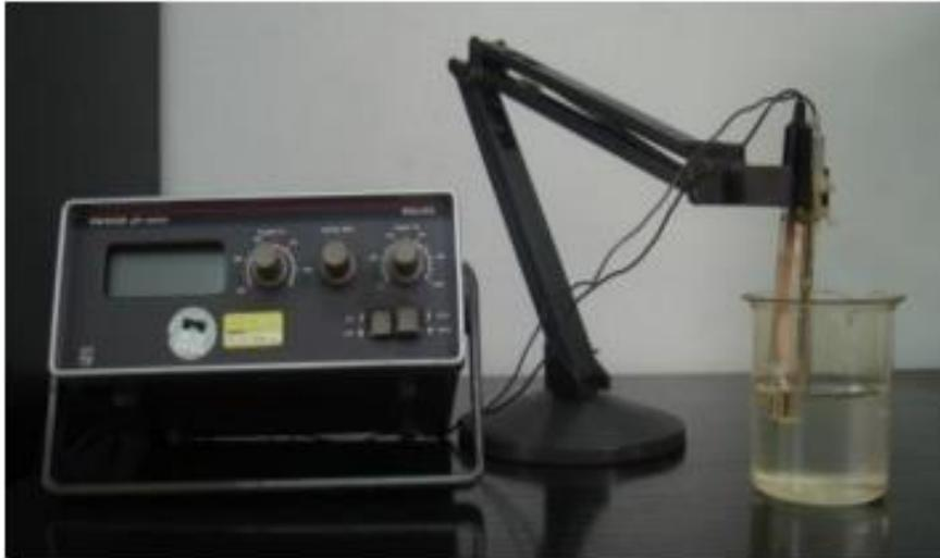
**Figura 4.** Instrumento empleado para las determinaciones del pH.
