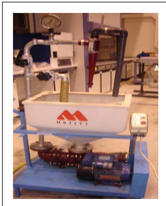
Figura II. 21 Hidrociclón 50,8 mm fondo cónico (C124) empleado en el deslamado.
