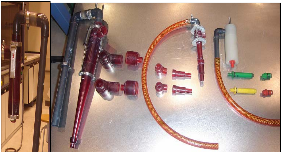
Figura II. 23 Hidrociclones de diámetro: 50,8 mm (fondo plano y cónico), 25,4 mm y 10 mm; (de izquierda a derecha).
