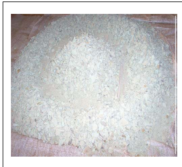
Figura II.5. Homogenización y cuarteo por el método del anillo y el cono.
