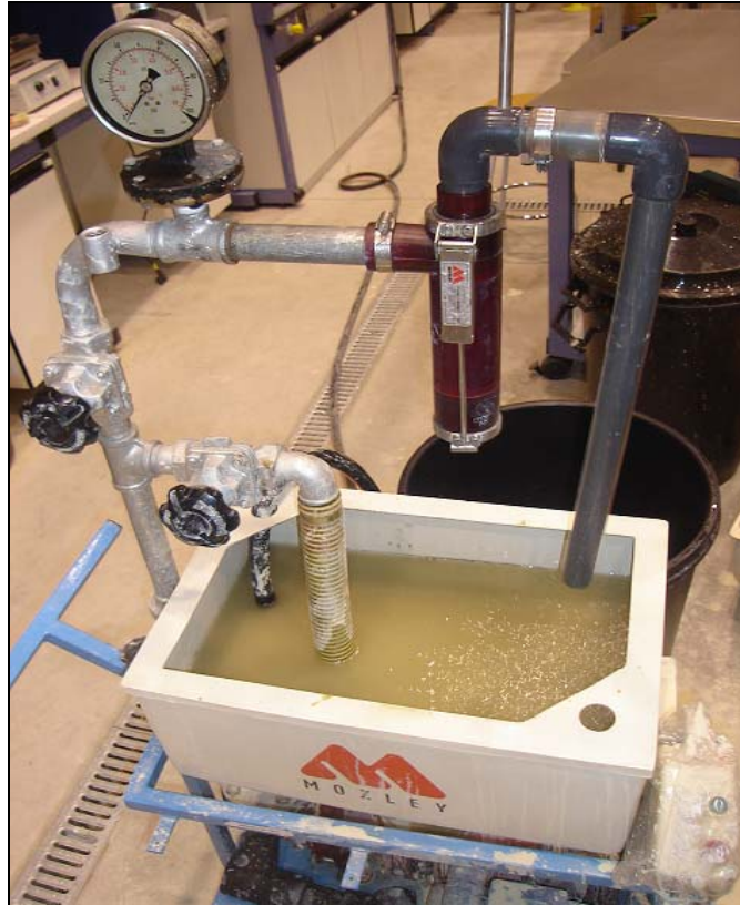
Figura II. 24 Hidrociclón de diámetro 50,8 mm y fondo plano con extensión
