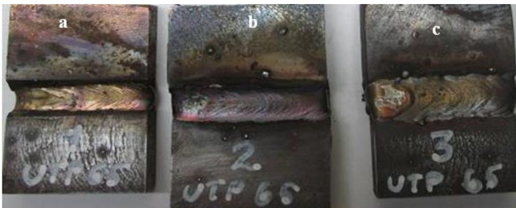
Figura 1. Unión soldada con el electrodo UTP 65. (a): depósito de un cordón de soldadura; (b): depósito de dos cordones de soldadura; (c): depósito de tres cordones de soldadura.
