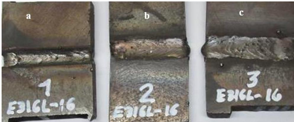
Figura 2. Unión soldada con el electrodo E 316L-16. (a): depósito de un cordón de soldadura; (b): depósito de dos cordones de soldadura; (c): depósito de tres cordones de soldadura.
