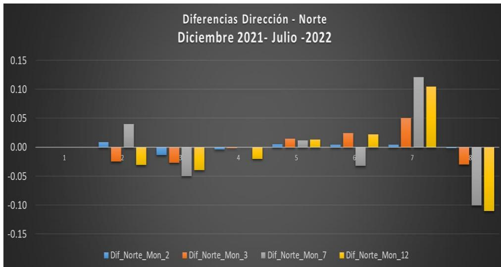
**Figura 32:** Resultados del control de los monumentos topográficos dirección norte.
