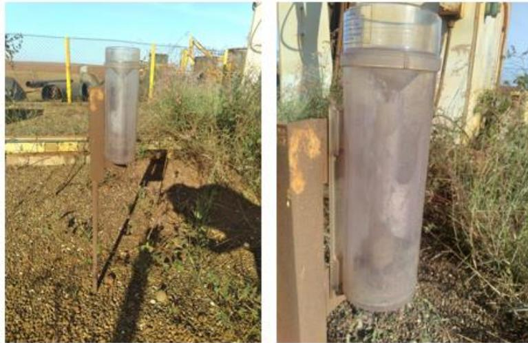
**Figura 26:** Pluviómetro empleado en el monitoreo de las precipitaciones en la presa de cola.
