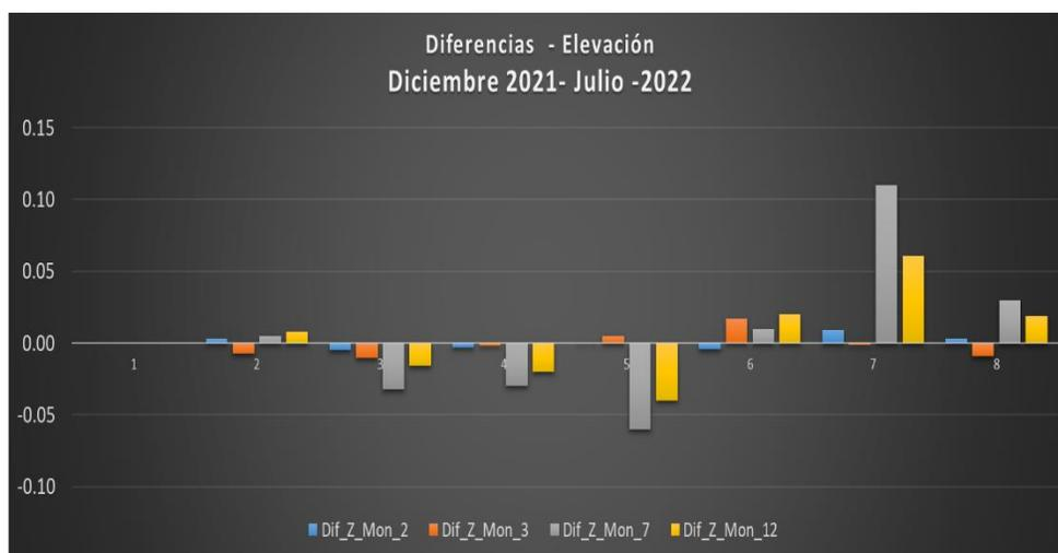
**Figura 33:** Resultados del control de los monumentos topográficos, dirección vertical (Z).
