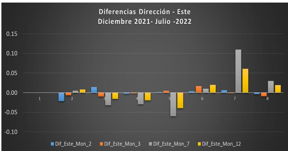
**Figura 31:** Resultados del control de los monumentos topográficos en la dirección Este.
