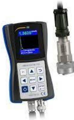
**Anexo D:** Acelerómetro.
