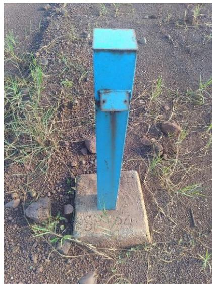
**Figura 24:** Monitoreo de las aguas subterráneas en los diques de la presa de cola.
