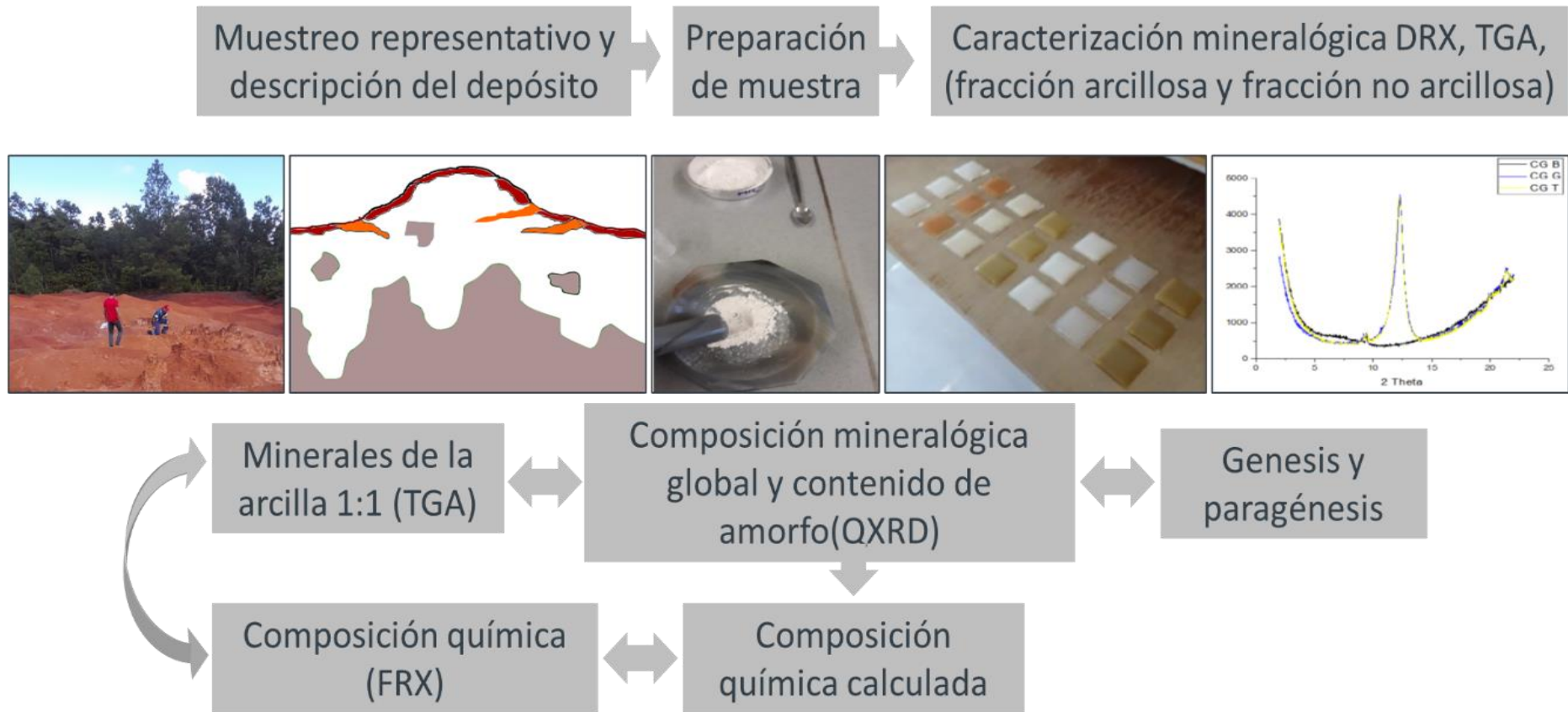
Figura 31: Propuesta de metodología integral para la caracterización de depósitos de arcillas por el método de Rietveld con el uso de un patrón interno.
