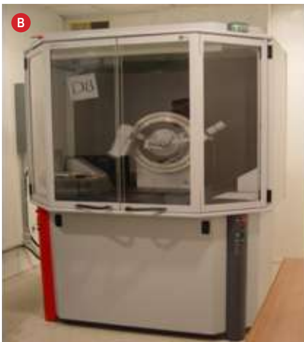
FIGURA 2. Difractómetro de Rayos-X, empleados para los análisis mineralógicos. a). difractómetro Siemens, modelo D5000; b). difractómetro Bruker AXS D8 Focus.
