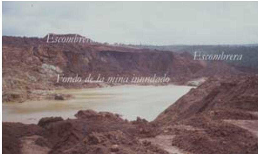
**Figura 3.** Vista de la mina a cielo abierto de uno de los yacimientos de níquel en explotación, se observan las diferentes acumulaciones de los estériles mineros en las escombreras y la inundación por agua en la parte baja (Rodríguez, 2002).
