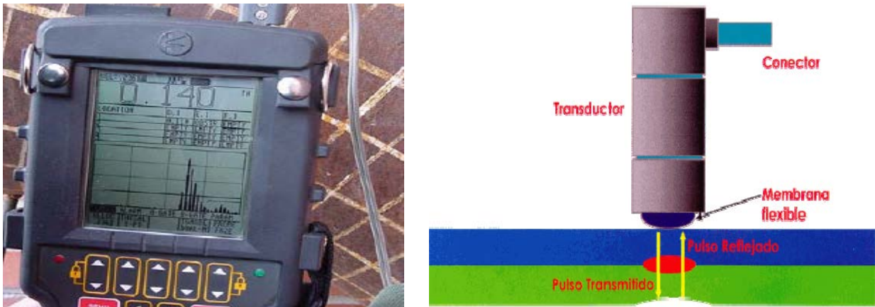
Figura 1.2. (a) Equipo de ultrasonido; (b) esquema general del proceso.
