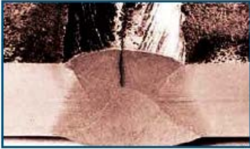
Figura 1.7. Agrietamiento en caliente en un acero inoxidable. Fuente: Muñoz (2009).
