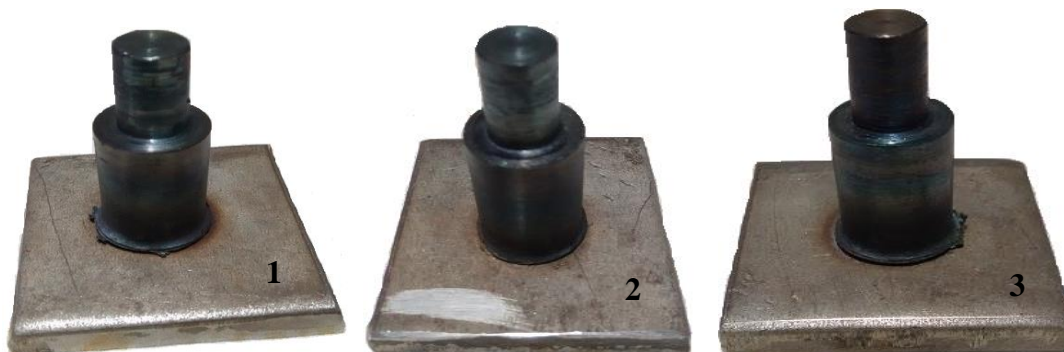
Figura 2.1. Probetas obtenidas luego del proceso de soldadura.
