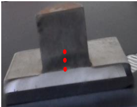
Figura 2.4. Zonas para la medición de durezas.
