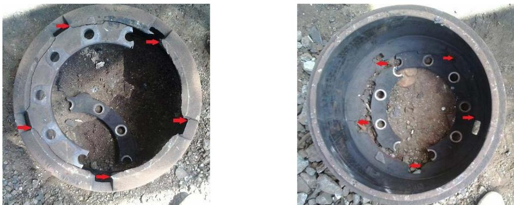
Figura 3.3. Apreciación de las zonas colapsadas
