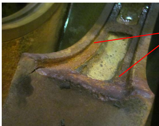
Figura 2.1. Desgaste en el cuerpo de la bomba Hazleton.
