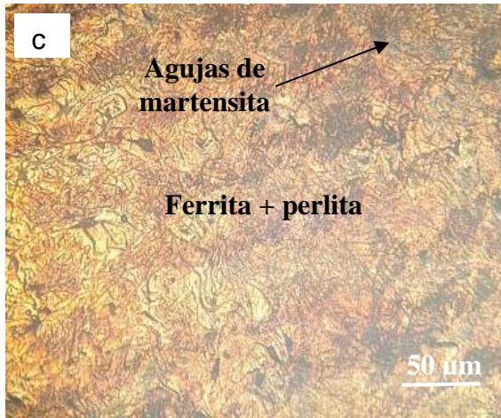
3.1c. Zona afectada térmicamente HF.
