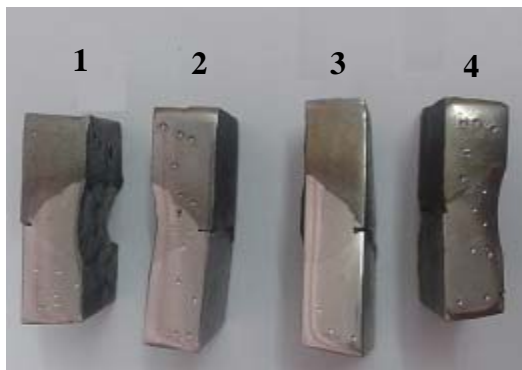
Figura 2.5. Preparación metalográfica de las muestras soldadas.
