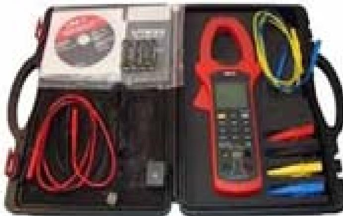
**Figura 2.12.** Amperímetro de gancho
