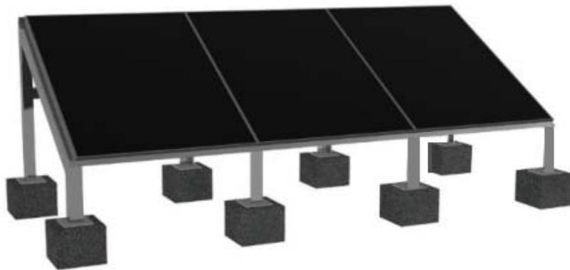
Figura 3.10. Base para los paneles fotovoltaicos [46]
