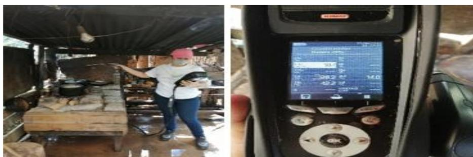
**Figura 3.8.** Medición del CO en una vivienda
