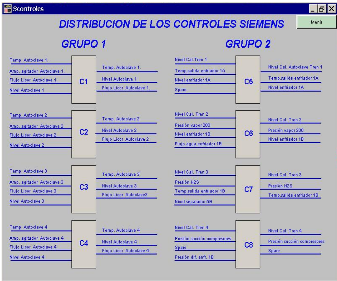
Figure 2.8.1. Elementos de control y ventana agregada al CITEC.
