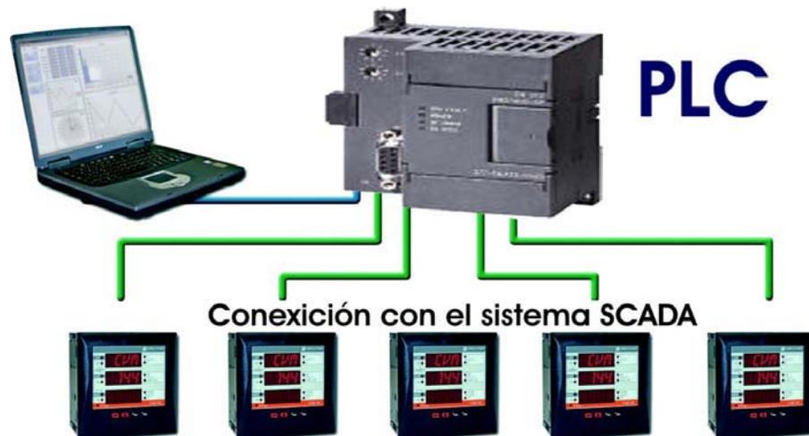
Figura 2.11 Ejemplo de una conexión de analizadores de redes con PLC.
