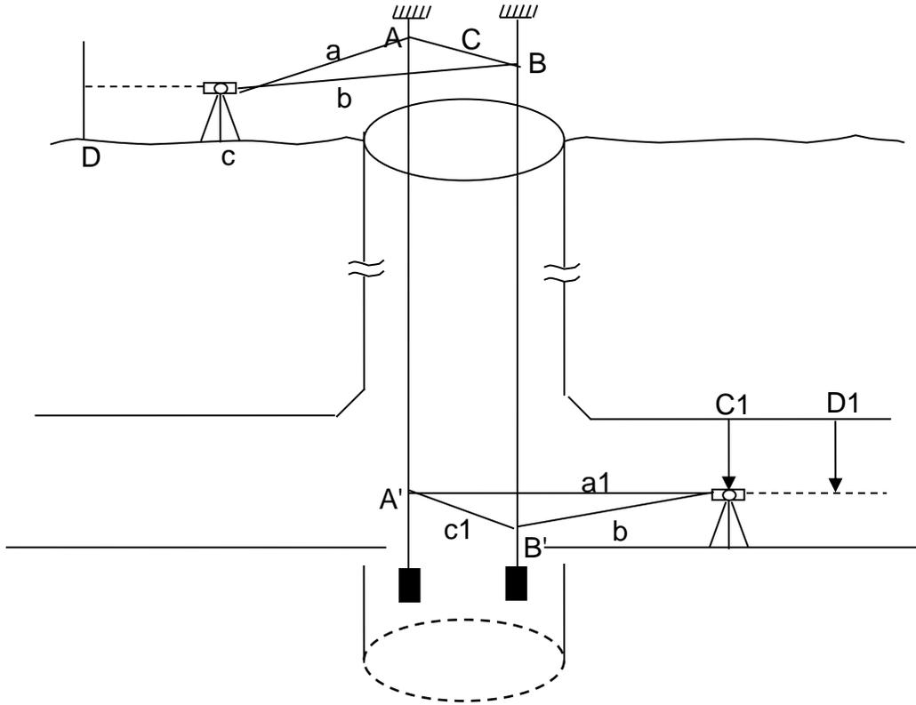
3.1 Vista en planta del método triángulo de enlace
