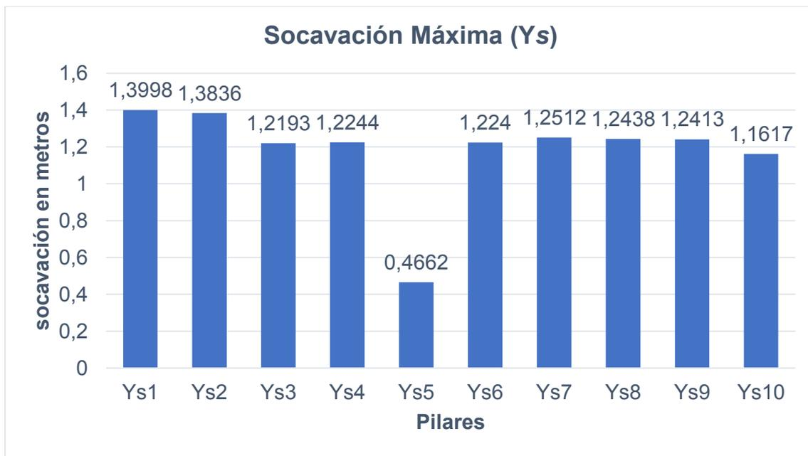
Figura 27. Socavación Máxima en los pilares del puente sobre el río Cabaña.
