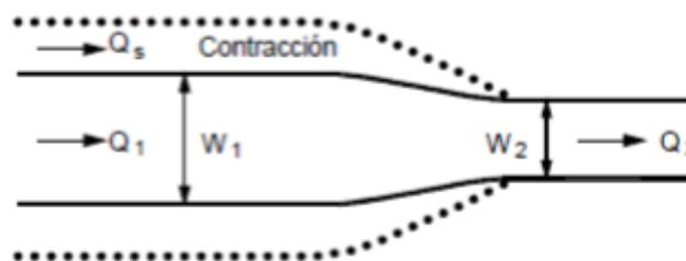
Figura 5. Esquema de la contracción de un cauce.
