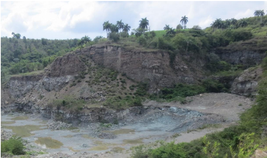
Figura: 4 Sistema de explotación por bancos descendientes.
