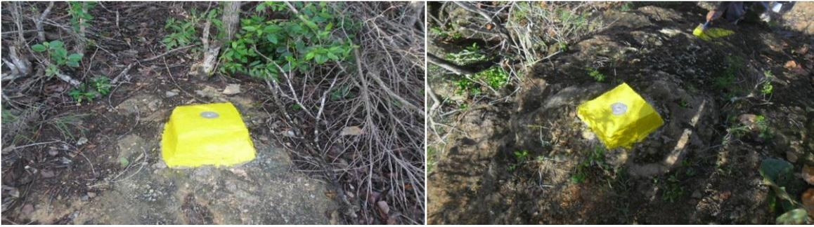
Figura 3.1 Modelo de monumentos topográficos sobre roca
