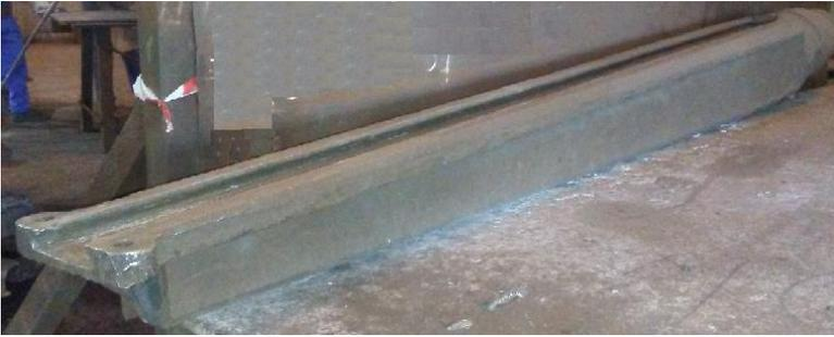
Figura 2.2. Brazo de barrido empleado en los hornos de reducción.
