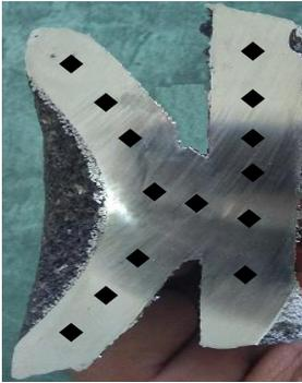
Figura 2.6. Medición de durezas en las diferentes zonas.
