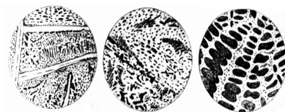
Figura 1.3. Estructuras de la fundición blanca. Fuente: Rojas *et al.* (2000).
