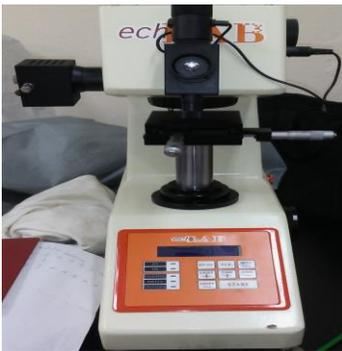
Figura 2.5. Durómetro digital modelo HRS-ISO.
