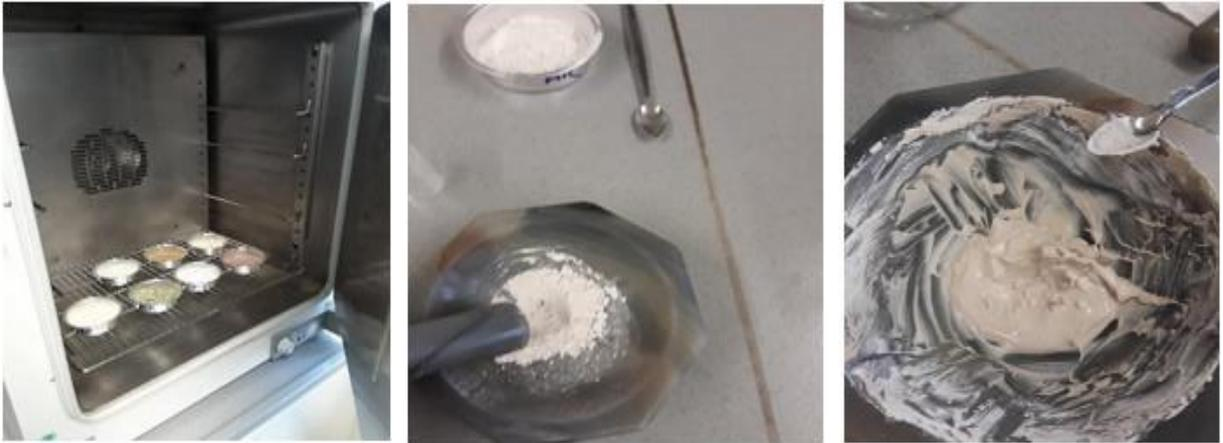
*Figura 15 - a) Mufla con ventilación interna, b) mortero de ágata, c) pasta resultante luego de la molienda en húmedo.*
