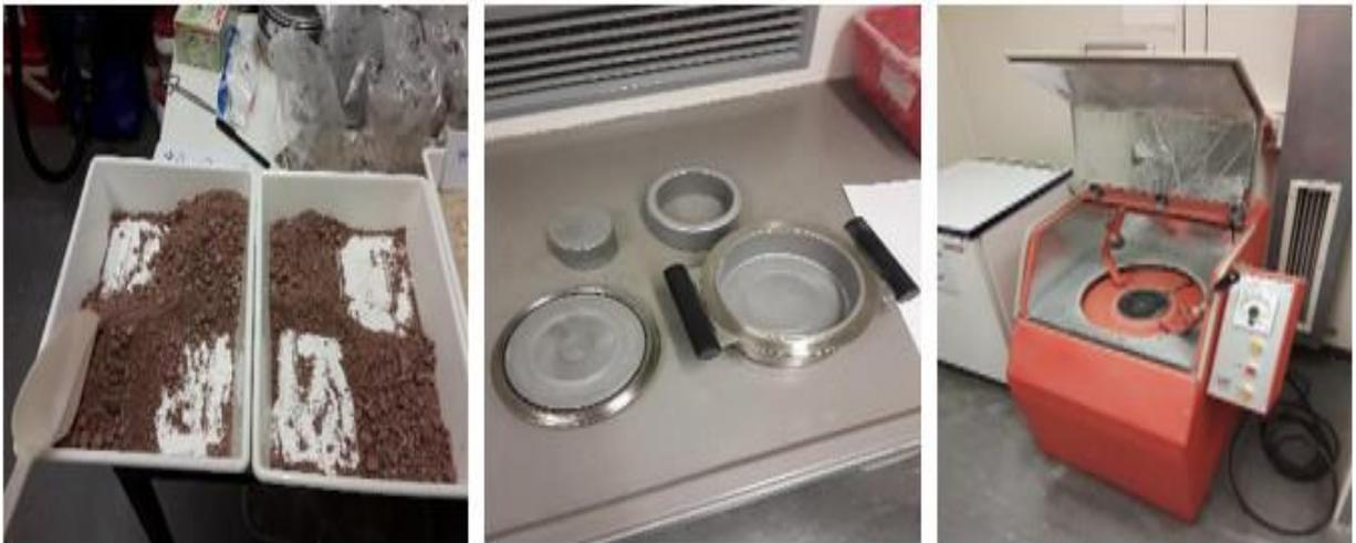
*Figura 14 - a) cuarteo en bandejas, b) accesorios del molino de anillos, c) molino de anillos*
