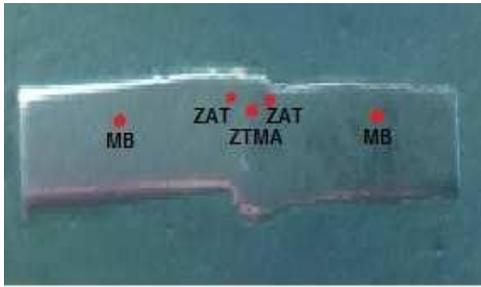
Figura 2.5. Medición de durezas en las diferentes zonas
