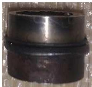
Figura 2.4. Superficie de la muestra con corte transversal de ambas aleaciones
