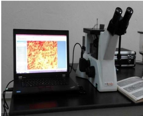
Figura 2.7. Microscopio óptico reflexivo
