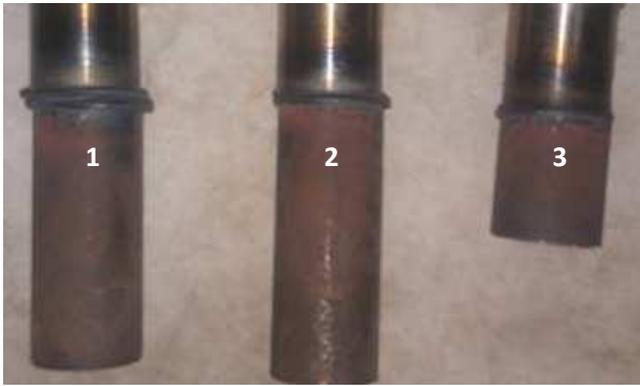
Figura 2.3. Probetas obtenidas luego del proceso de soldadura
