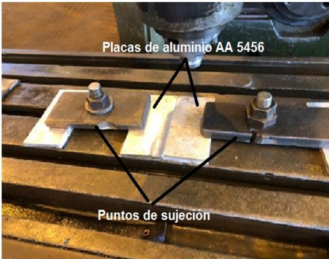
Figura 2.8. Material base utilizado para la unión.
