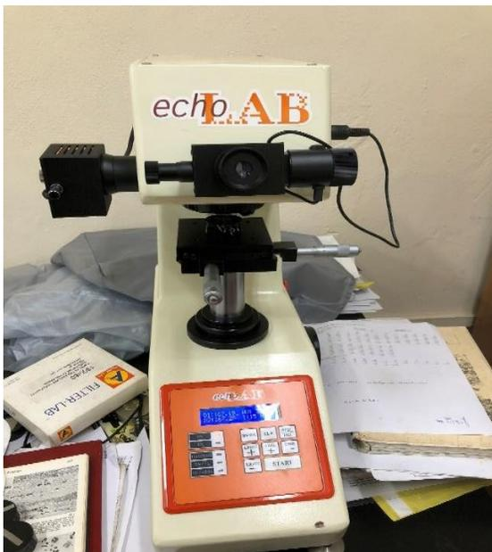
Figura 2.4. Microdurómetro CARMANO.
