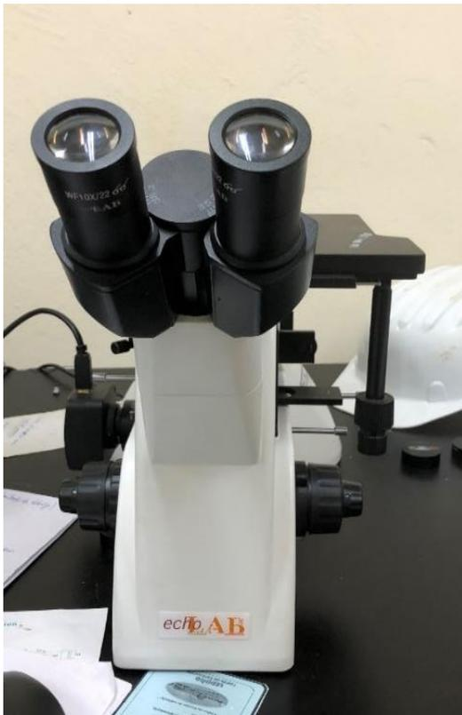
Figura 2.2. Microscopio óptico WF 10X/22.
