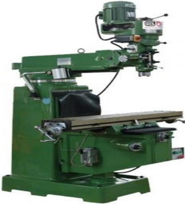
Figura 2.7. Fresadora utilizada en el proceso de soldadura por fricción y agitación.
