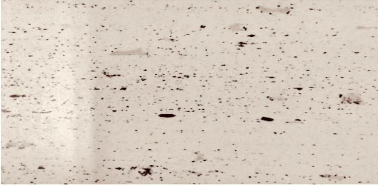
Figura 2.3. Microestructura de la aleación de aluminio AA 5456.
