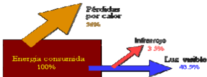
Figura 1.16: Balance energético de una lámpara de vapor de sodio a alta presión.
