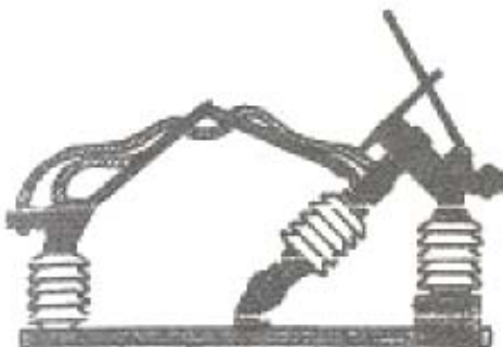
Figura 1.7 Desconectivo en aire.
