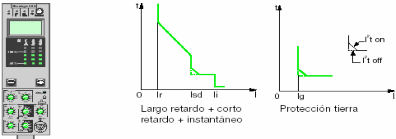
Figura 6: Partes de la unidad electrónica micrologic 6.0A del interruptor Masterpact
