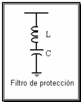
Figura 2.12: Topología del filtro de protección.
