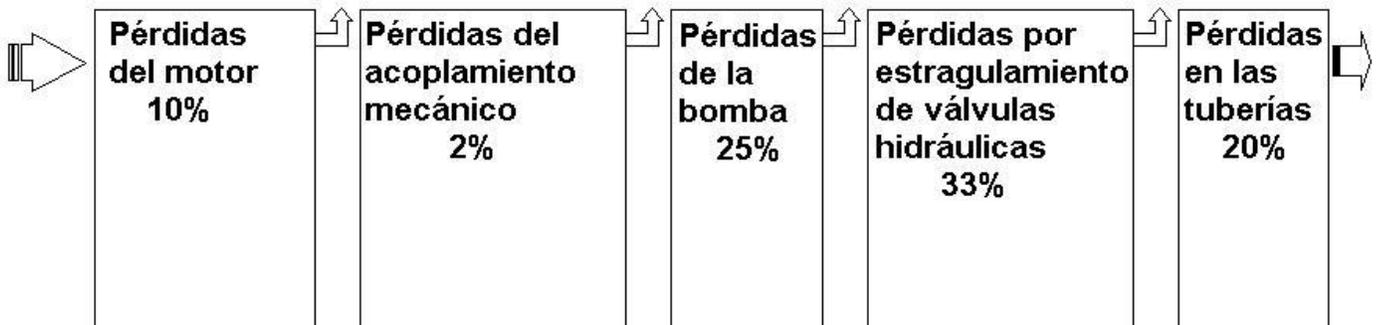
Figura 1.3. Diagrama de pérdidas en un sistema de accionamiento eléctrico de bombas
