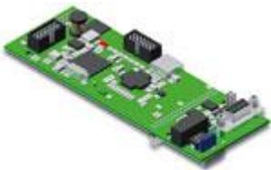
La serie SD700 ofrece una oferta muy completa de interfaces de comunicación, tales como Modbus-RTU, Profibus-DP, Ethernet, DeviceNet, N2 Metasys... Bajo la perspectiva de la simplificación y mejora de las instalaciones, la integración del SD700 en las redes de comunicación, abre aún más las posibilidades de monitorización y gestión tanto del equipo como del sistema.
