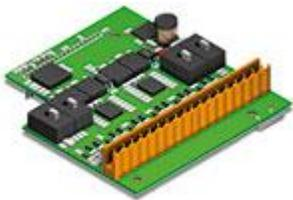
La serie SD700 dispone de tarjetas opcionales de Encoder, lo que permite disponer de 2 Encoders diferenciales (uno para el usuario y otro para el control vectorial) trabajando de 5 a 24Vdc, según sea preciso.
