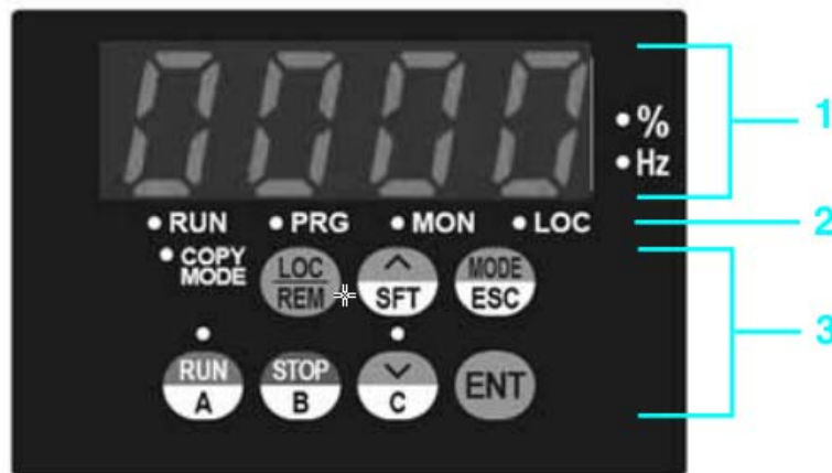
Panel frontal del terminal de visualización remoto
