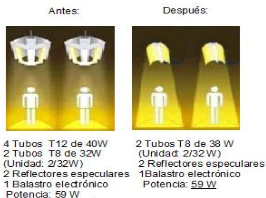
Fig.1.6 Cambio de lámparas de 40 W por lámparas de 32 W
