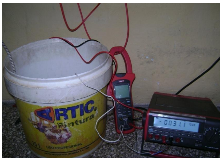
Anexo 3 Imagen de la prueba realizada de calentamiento de agua de varios volúmenes con el calentador eléctrico.
