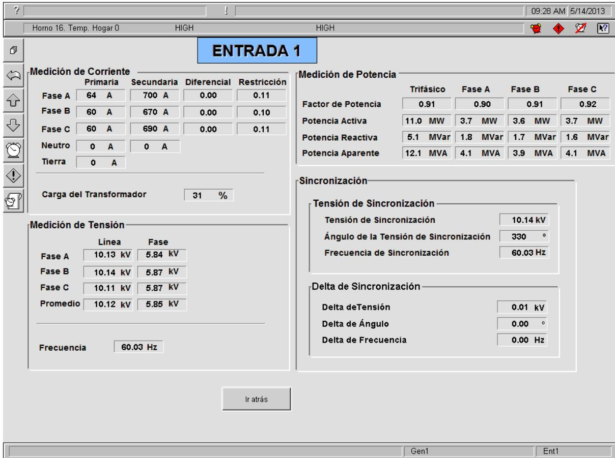
**Figura 1.** Pantallas de supervisión de la entrada 1T montadas en el CITECT para el nodo principal de la empresa.
