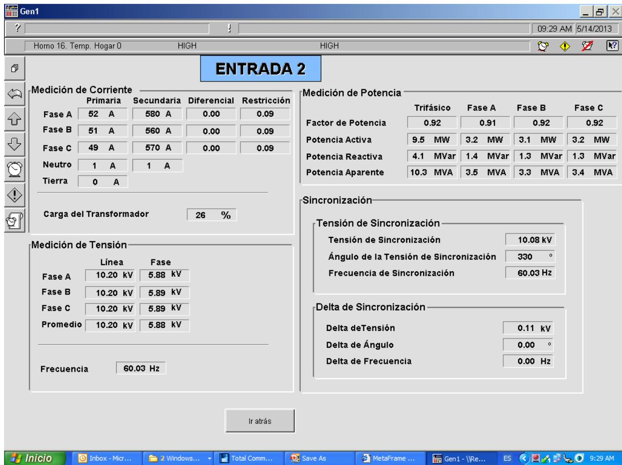
**Figura 4.** Pantallas de supervisión de la entrada 2T montadas en el CITECT para el nodo principal de la empresa.
