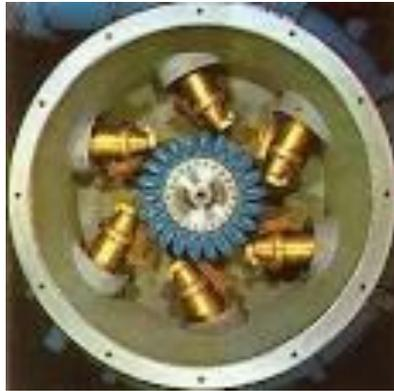
En la figura 1.3 se muestra un ejemplo de Turbina Pelton.
