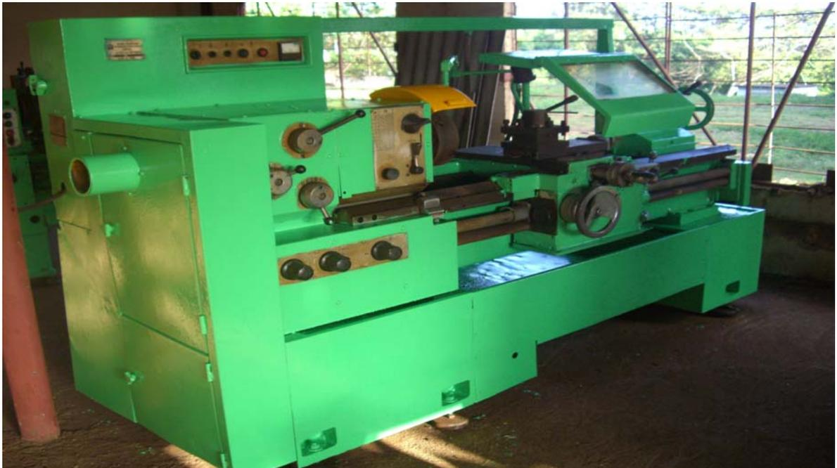
Figura 3.8. Vista frontal del torno 16 D 20 recuperado.
