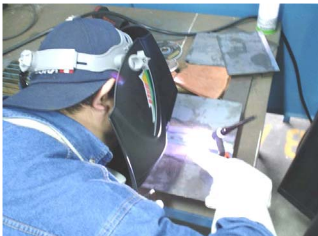
Figura 2.4. Soldeo sin material de aporte de probetas.
