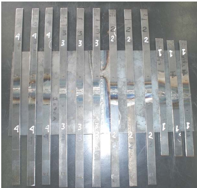
Figura 2.7. Probetas soldadas para el ensayo de tracción.
