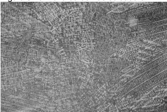
Figura 3.1e. Estructura de ferrita con carburos dispersos.
