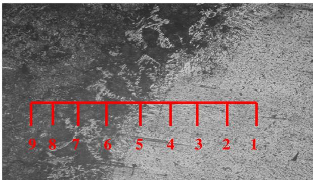
Figura 3.6. Distribución de barrido de dureza.
