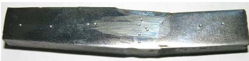
Figura 2.9. Selección de puntos para el análisis de la dureza.
