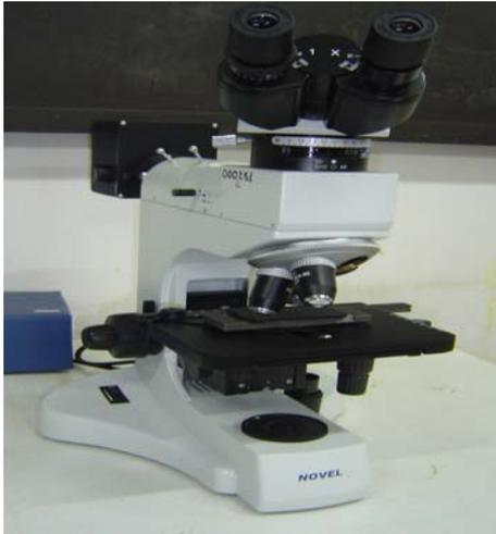
Figura 2.6. Microscopio óptico NOVEL modelo NIM - 100
