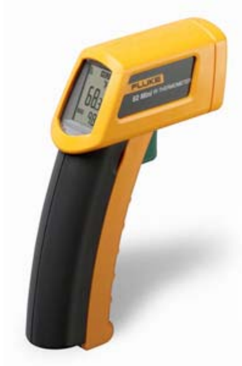
Figura 2.1 El Fluke 62 Mini. Termómetro infrarrojo
