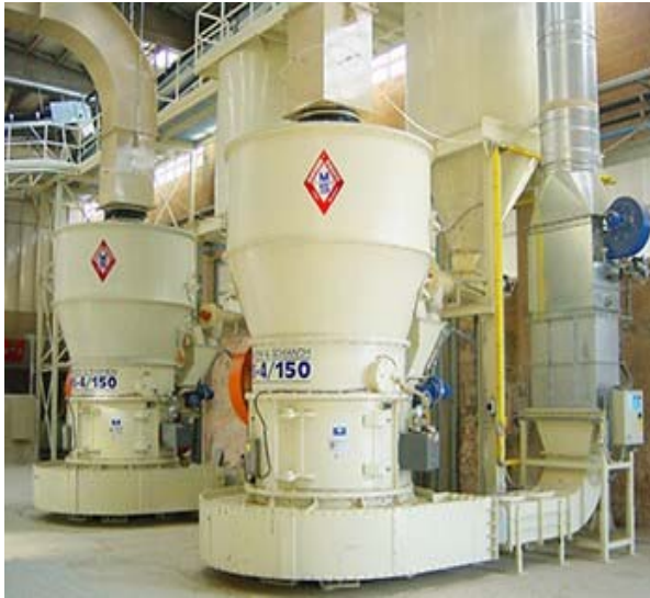
Figura 1.1. Molino de rodillos verticales.
