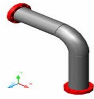
Figura 10: Compensador de Lira en omega reducidos
