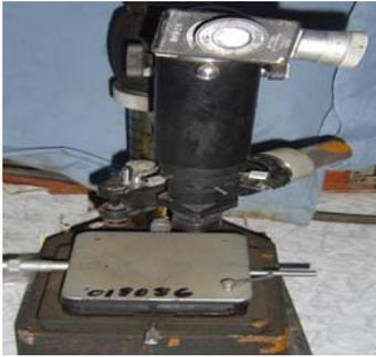
Figura.2.4. Microscopio utilizado para el ensayo de microdureza.
