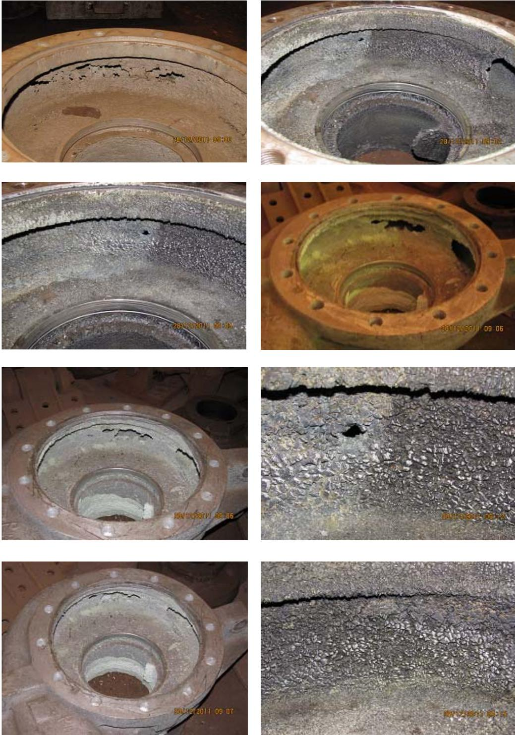
Figuras 3.1. Efecto de la concentración de pulpa en el cuerpo de la bomba.
