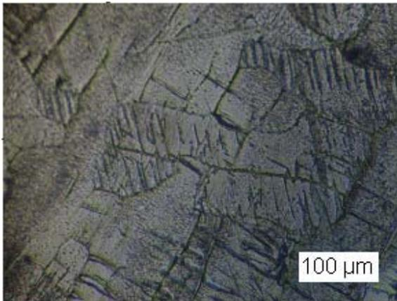
Figura 3.10. Microestructura del tipo  $\alpha$  de la aleación TI - 6 AL - 4V.
