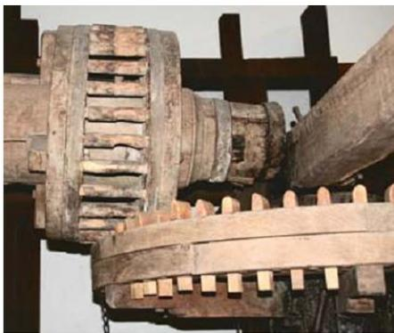
**Figura. 1.1.** Transmisión de ejes concurrentes con empleo de un engranaje de linterna.
