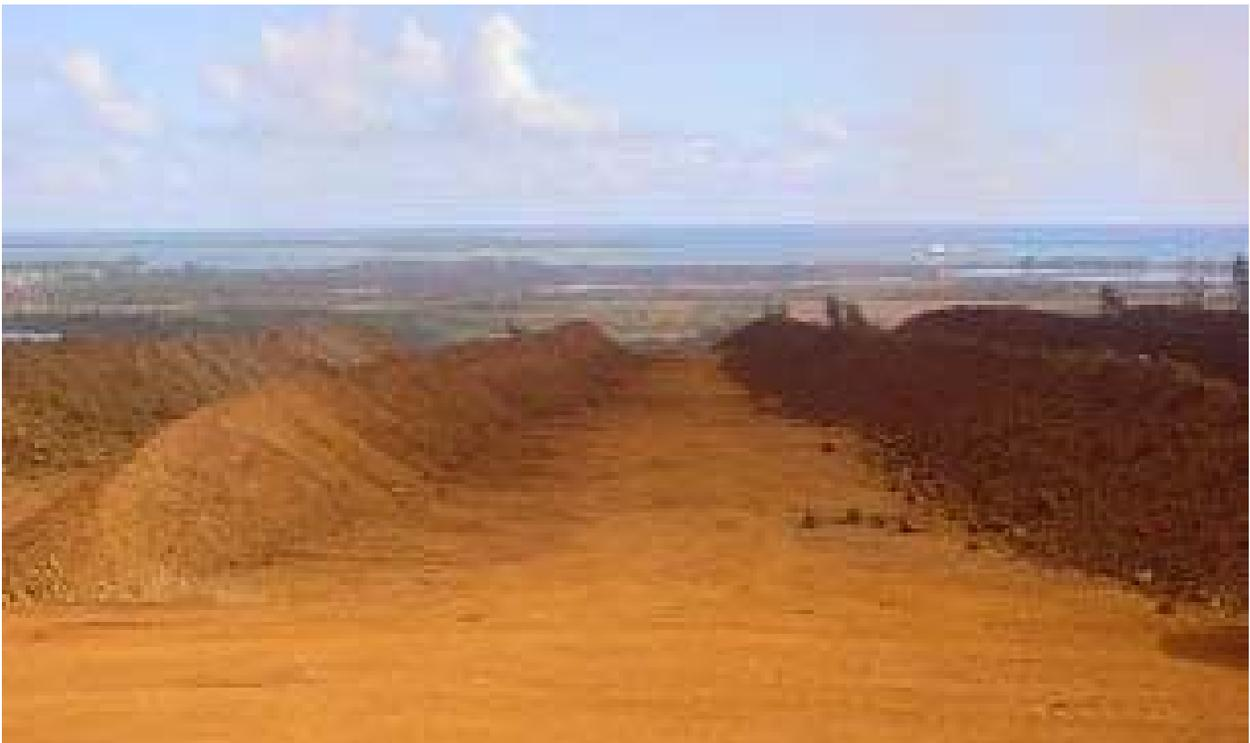
**Figura 1.1.** Implementación del secado natural de las menas lateríticas en Moa.
