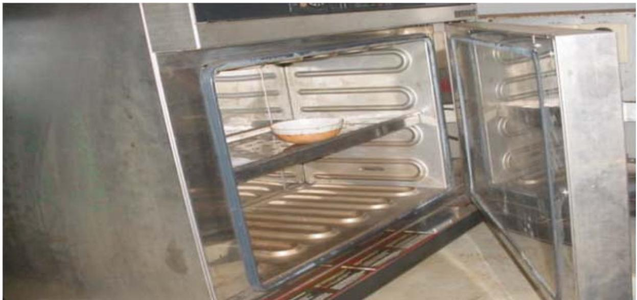
**Figura 2.** Estufa empleada para el secado de las muestras de menas lateríticas.
