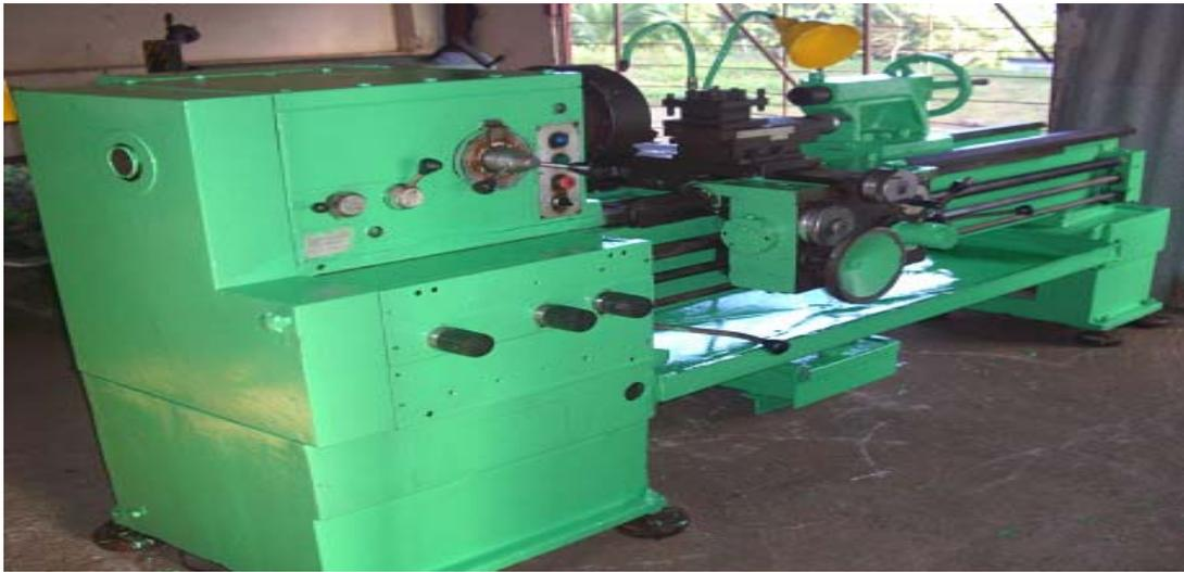
Figura 3.10. Vista general del torno C 11 MT reparado.
