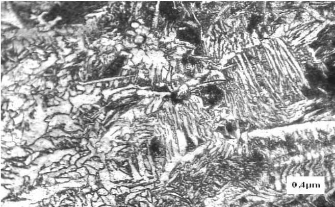
Figura 3.13 Soldadura de la unión brida – tubo con  $CO_2$  (400 X).
