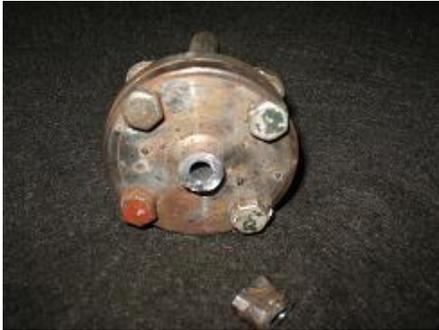
Los resultados de las probetas sometidas al ensayo de torsión después de ser soldadas, son evaluados satisfactorios, debido a que el problema está dado en el materia base no en el materia de aporte. Según el reporte de esta prueba se recomienda el empleo del
