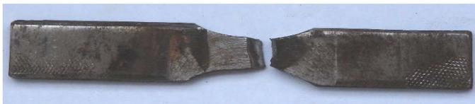
Figura 3.4 Probeta después de realizarle el ensayo de tracción.
