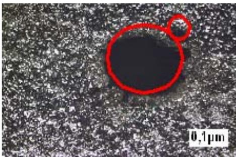
Figura 3.10. Presencia de poros en la soldadura de tramo 3, (100 X).
