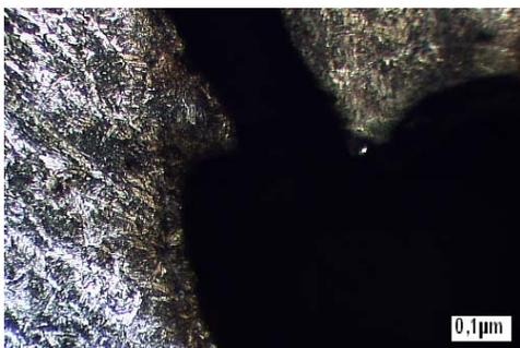
Figura 3.11. Presencia de grietas en la soldadura de un tramo 4, (100 X).
