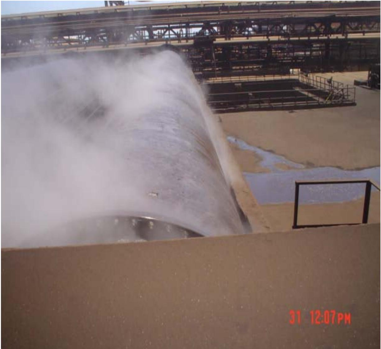
**Figura 5:** Vista superior de la de un enfriador mineral, en la imagen se puede observar fácilmente el proceso de ebullición y evaporación de la película de agua.
