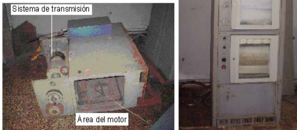
Figura 2.1. Simulador de desgaste CMT 2070 – 1.
