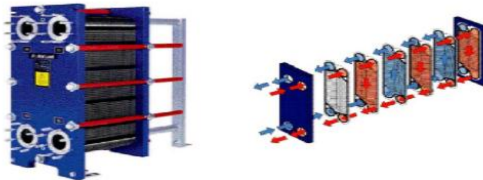
Figura 1.12. Componentes del intercambiador de placas. Fuente: Izquierdo, (2002).
